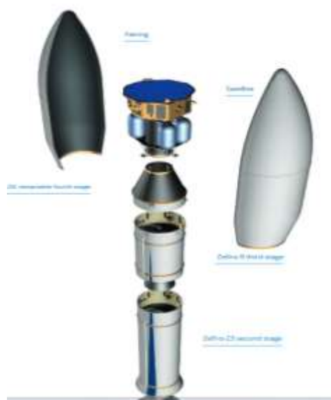
شکل ۱. نمای قطعات و جیدمان سامانه VEGA
