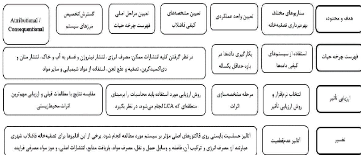
شکل ۳. چارچوب کلی پروپوزال تهیه شده جهت کمک به توسعه کاربرد LCA در تصفیه‌خانه‌های فاضلاب
