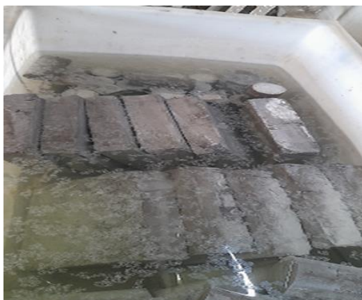
شکل (۲): عمل‌آوری نمونه‌های بتنی
